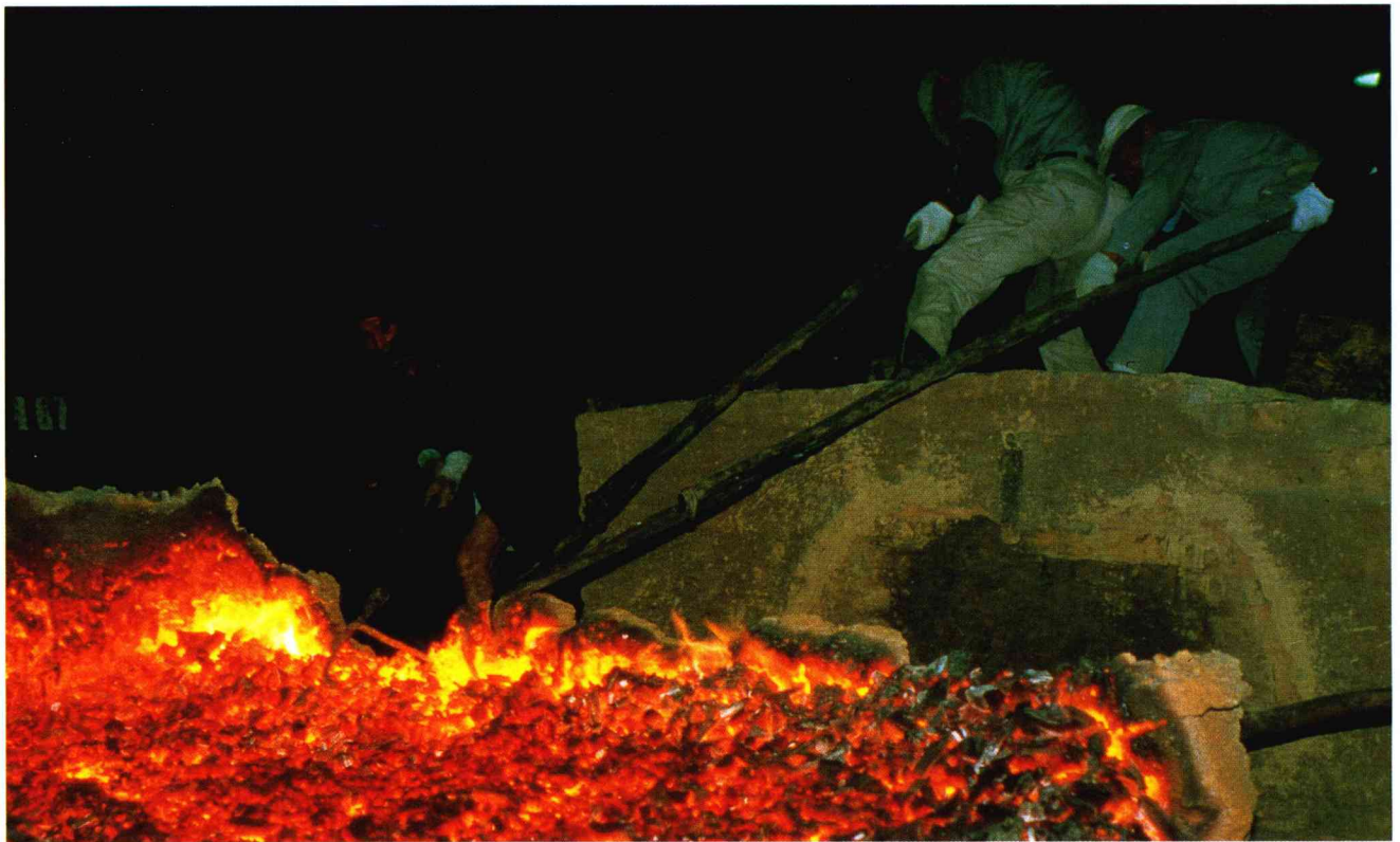
冬期、1月から2月にかけてが、たたら製鉄のシーズン。 操業がはじまると、風を送る ふく の音で空間は満たされていく。 荘厳に燃え盛る炎には火の神「金屋子様」が宿るとされ、たたら製鉄には火の神に対する信仰という側面もあった。 写真は、操業の後、炉をとり壊すところ。
