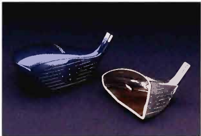
ドライバーヘッドのカットサンプル (ミズノ・ノータススーパーチタン)。 肉薄でできるだけ軽量化を図りながら、 ソール面を肉厚にして安定性を高めている
