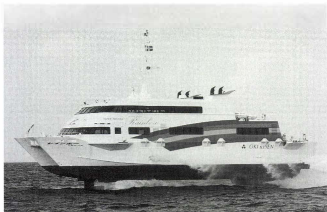
図8 全没型水中翼双胴船 三菱スーパーシャトル400
