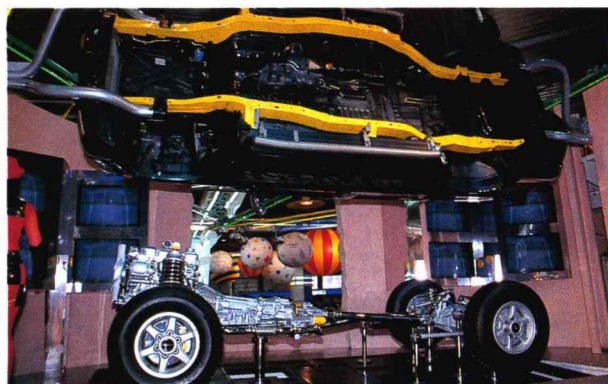
フルモデルチェンジしたニッサン「テラノ」の展示。鋼製の「モノフレームボディ」は、従来型に比べ約85kgの軽量化を達成し、高い剛性が快適な乗り心地を実現した。
