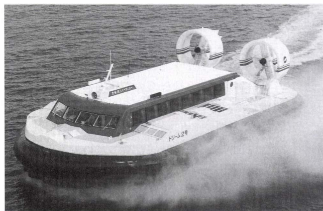
図10 全周スカート型エアクッション船 三井ホバークラフト ドリーム
