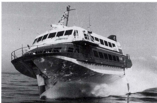
図7 全没型水中翼船 川崎ジェットフォイル
