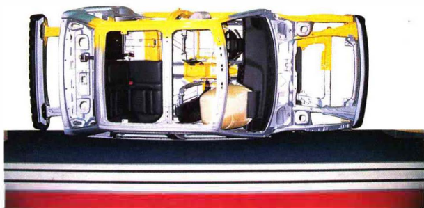
信頼性の高いボディ構造に強度にすぐれた多くの鋼材が使用されている (東京モーターショー会場にて)
