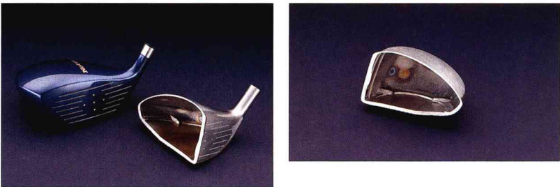
ドライバーヘッドのカットサンプル (ミズノ・ノータススーパーチタン)。 肉薄でできるだけ軽量化を図りながら、 ソール面を肉厚にして安定性を高めている
