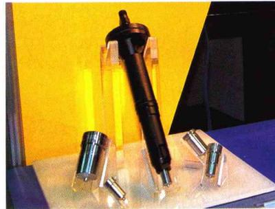
フューエルインジェクタの採用によって燃料が効率的にエンジンに供給されるため、有害物質の排出も少ない
