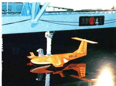
400m水槽におけるリピッシュ型の空力計測。翼や船体が受ける空気力とその影響を調べる
