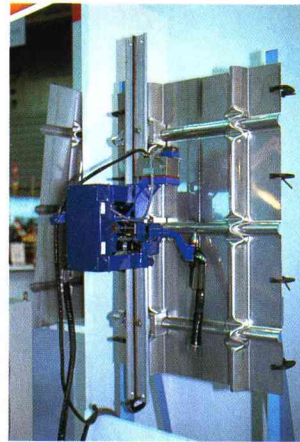
従来のものに比べ、2.5倍の溶接速度が可能になったメンブレンシート溶接ロボット
