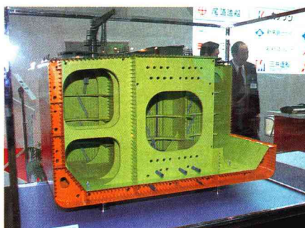
IMOのMARPOL条約に基づいて義務づけられたダブルハル構造のタンカー
