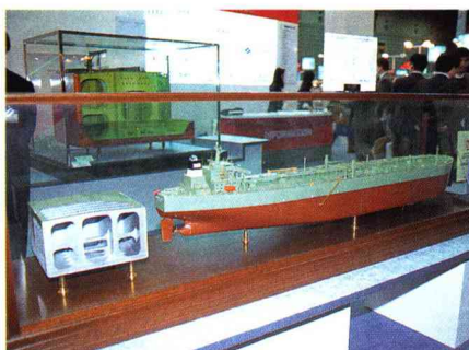
IMOのMARPOL条約に基づいて義務づけられたダブルハル構造のタンカー
