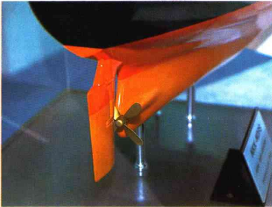
船の中心から少し右にずらしたプロペラで、水の流れを有効にして推進効率をあげるオフセンタプロペラ
