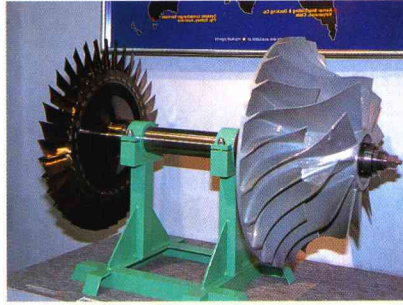
推進効率を高めるターボチャージャーの搭載が進んでいる
