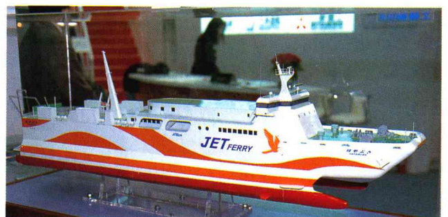
船体をアルミ製にして軽量化・高速化を可能にした日本初的大型高速カーフェリー
