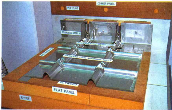
ガラス繊維で補強した発泡ポリウレタンの防熱材と1.2mm厚のステンレス板を合わせて作られているメンブレンシート
