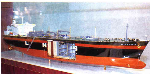
アルミ製タンクの搭載で、タンカー自体の軽量化を図ったSPB方式のLNGタンカー
