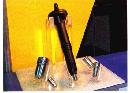
フューエルインジェクタの採用によって燃料が効率的にエンジンに供給されるため、有害物質の排出も少ない
