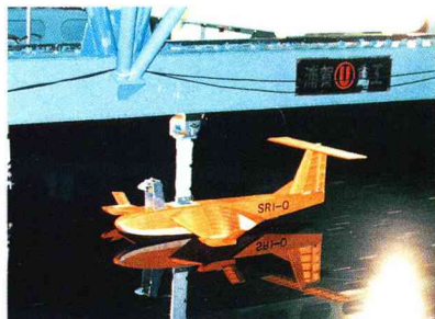
400m水槽におけるリビッシュ型の空力計測。翼や船体が受ける空気力とその影響を調べる
