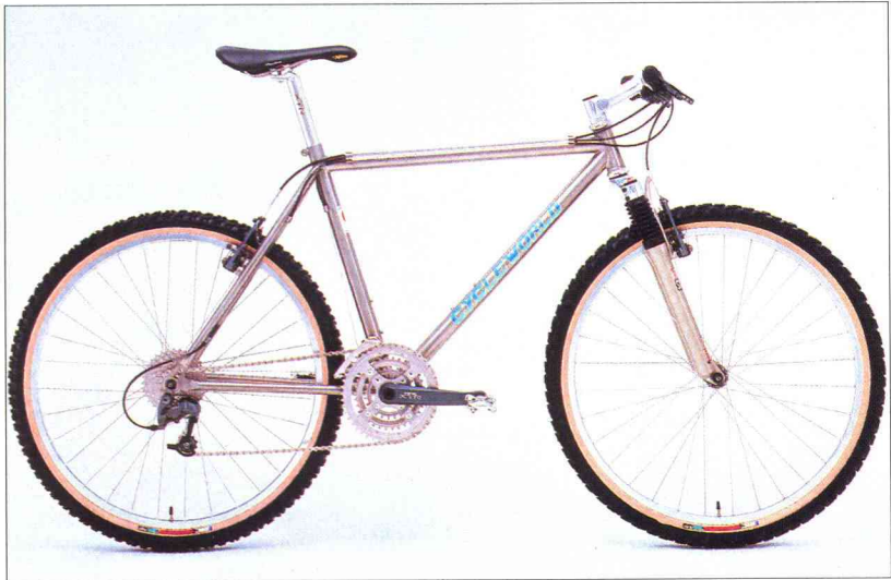
チタンフレームをベースに、耐久性をメインに考えたパーツがアッセンブルされた三浦選手のマウンテンバイク。フレーム重量はわずか1.4kg。
