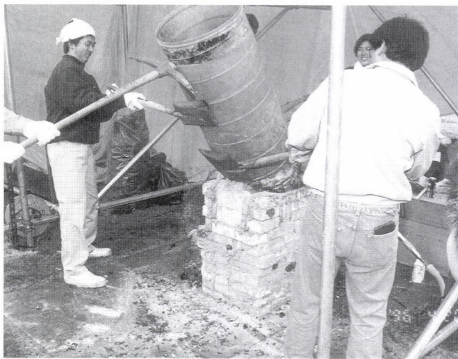
「たたら製鉄」の実演
