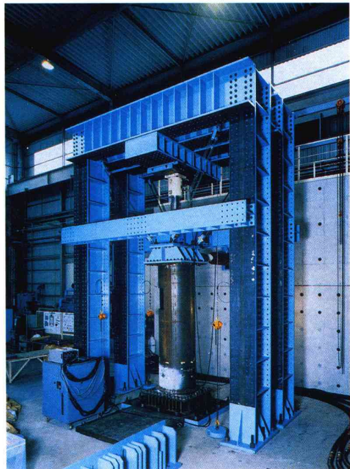
橋脚のハイブリッド地震応答実験装置
