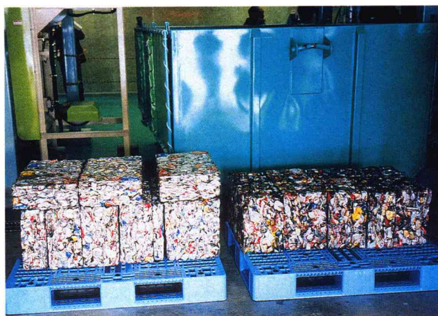
プレス機によって圧縮成形されたスチール缶 (北海道旭川市近文リサイクルプラザ)
