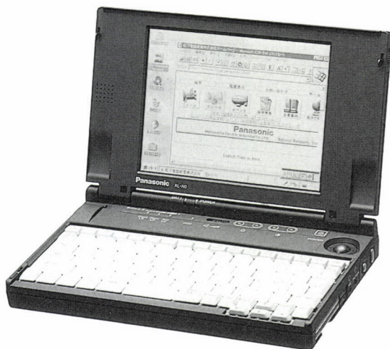
図1 サブノート型パソコン。ハウジングに炭素繊維強化熱可塑性プラスチックを用いているなどの効果で、重さが1.3kgと軽い
