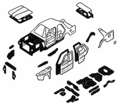
図14 車体での防錆鋼板の適用例 16) (着色部分が防錆鋼板)
