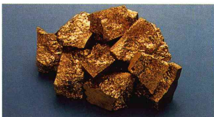
水素吸蔵合金の種類は10数種にわたるが、写真はランタンリッチミッシュメタルのニッケル系合金。左から塊状合金、粉碎したもの、水素吸蔵・放出を繰り返したもの（写真提供：日本重化学工業）
