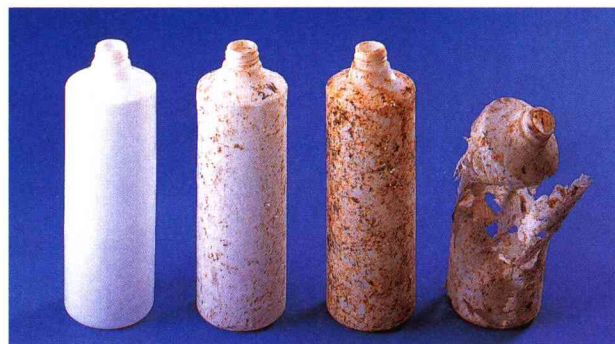
生分解性プラスチックの経時変化。左から新品、2週間経過、4週間経過、6週間経過の順（写真提供：昭和高分子）
