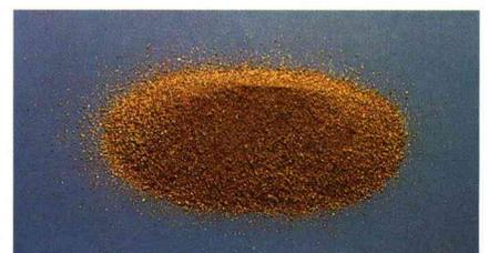
水素吸蔵合金の種類は10数種にわたるが、写真はランタンリッチミッシュメタルのニッケル系合金。左から塊状合金、粉碎したもの、水素吸蔵・放出を繰り返したもの（写真提供：日本重化学工業）
