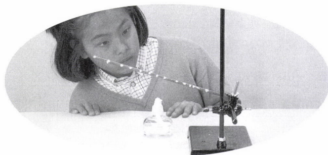
図5 金属の棒をななめにした時のろうのとけ方はどうか*
