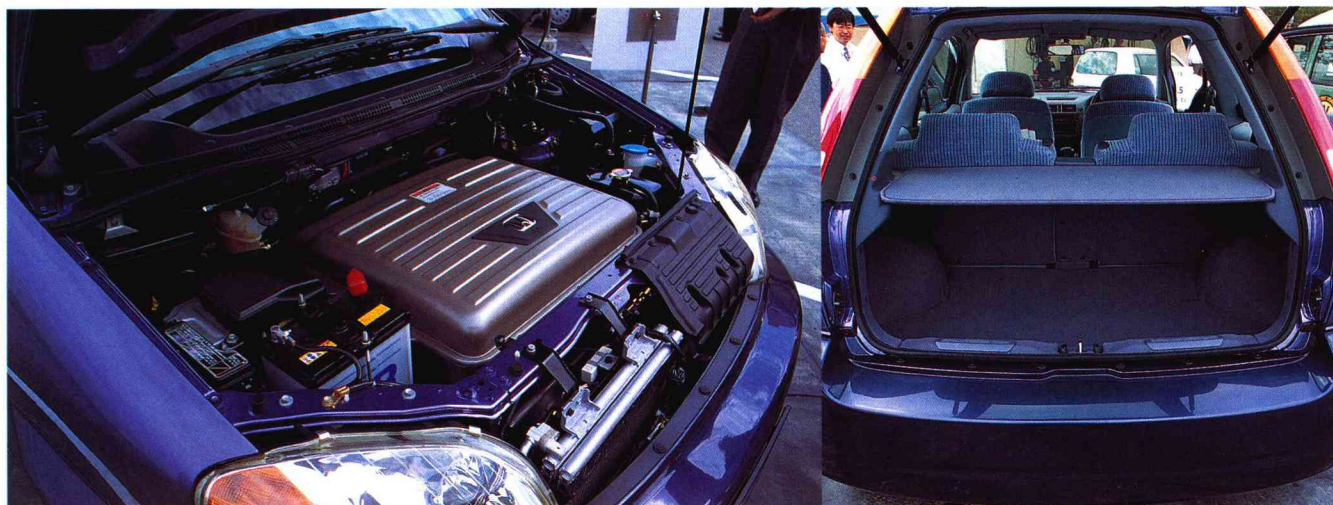
■本田技研が発表したHONDA EVのモータールームと荷室。EV専用ボディのため、容量が十分確保されている。RAV4L EVや日産のプレーリジョイEVなど、RVがベース車として利用されるのも、居住空間を犠牲にしないですむことが理由だ。(Photo:(C)畑中力 HATANAKA TSUTOMU)
