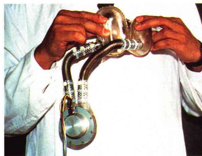
国立循環器病センターの人工心臓モデル 国立循環器病センターの「拍動流型」人工心臓。システム全体の大きさと、埋め込み時の位置関係がよくわかる。電気油圧式ポンプ・アクチュエーター（下の円盤状の部分）が正逆駆動し、2本のパイプに満たされたシリコンオイルを媒体にして左右ポンプを交互に圧縮・吸引する。オートマチック車のトルクコンバーターを連想させるメカニズムである
