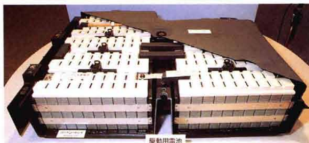
■市販されたトヨタRAV4L EV(上)。24個のニッケル水素電池が底部に搭載されている(下)。(Photo:(c)畑中力)
