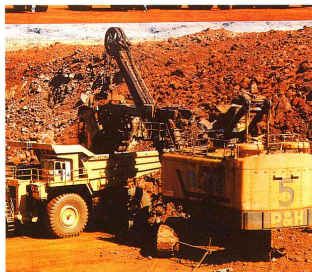
電気パワー・シャベルですくい上げた鉄鉱石を190トン積トラックに積み込む
