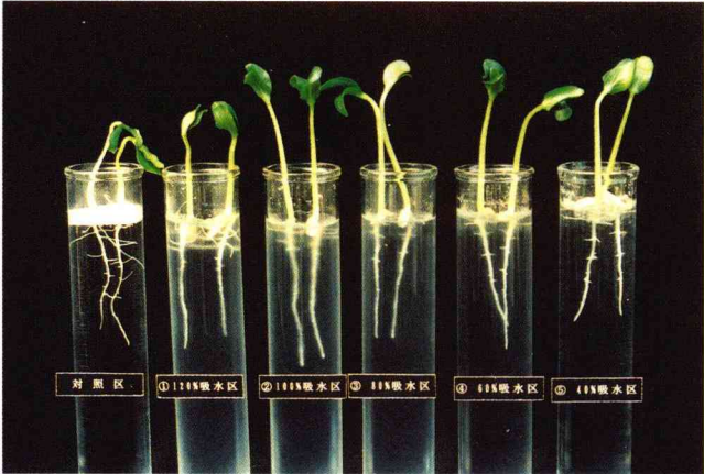
PNVAを用いた栽培実験。従来のアニオン系吸水性樹脂と異り、発芽発根の阻害が無い。左端が対象区。順に120%吸水区、100%吸水区、80%吸水区、60%吸水区、40%吸水区
