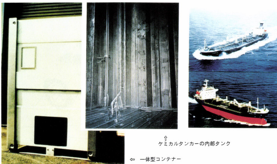
図13 ステンレス鋼を使用したケミカルタンカーの内部タンク及び一体型コンテナ
