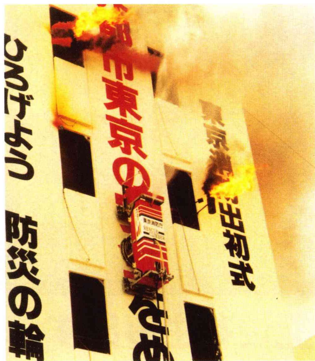
吸盤による壁面昇降技術を 採用した東京消防庁のレス キュー用ロボット
