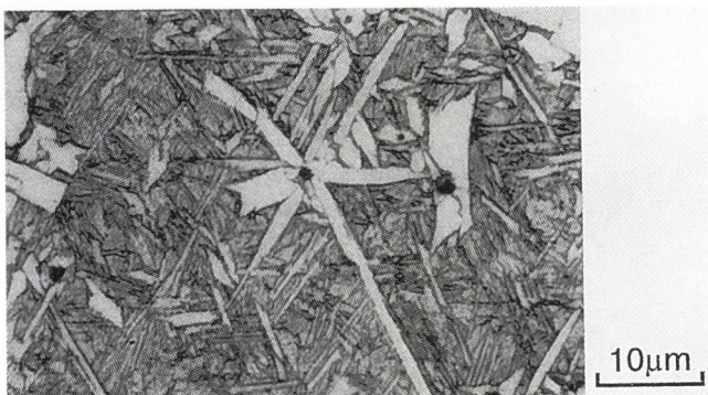
図5 溶接金属中の酸化物からのアシキュラーフェライトの生成 (オーステナイトフェライト変態途中から焼入れ)
