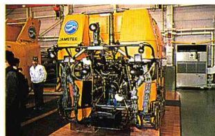
「しんかい6500」のチタン合金製マニピュレーター
