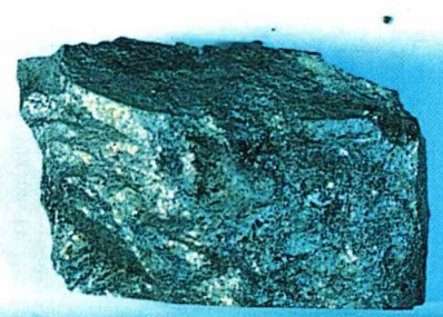
引揚げられた資料の一部。写真のものは黄銅鉱が混ざる塊状黄鉄鉱
