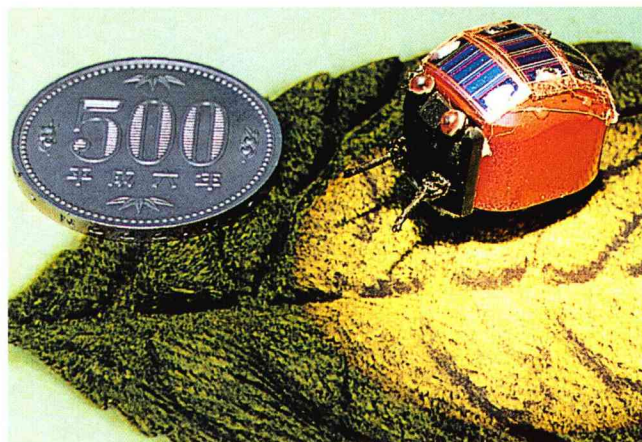
光電変換デバイスを1cm×1.5cmの昆虫型アクチュエータに曲面実装している。
