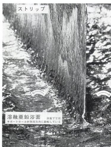
図10 亜鉛浴面とストリップ表面を流れ落ちる溶融亜鉛 (画面直上に装備されたノズルにより)
