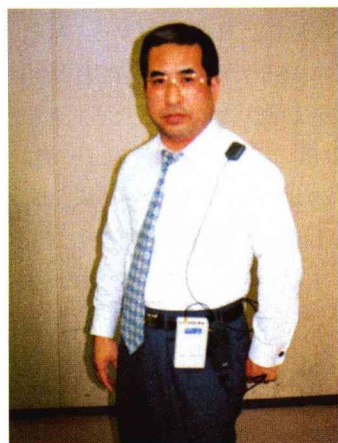
システムを装着したところ。ベルトに受信機と携帯電話が下げられ、肩にアンテナが乗せられている。実用にあたっては小型化・一体化がめざされる。モデルはNTTデータ通信の工藤氏（本誌登場）
