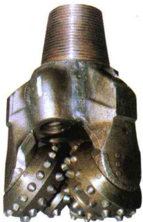
地熱の掘削に使われるトリコーンビット。タングステン・カーバイト製の3つの刃先を回転させることで岩盤を掘削する
