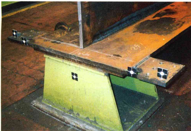
3次元自動計測装置による計測の様子
