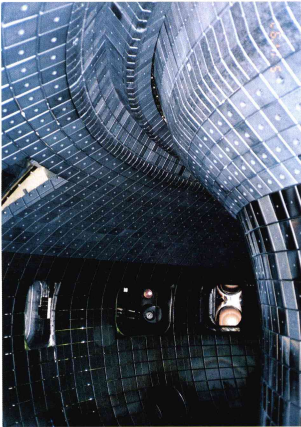
1997年6月に改造が終了したJT-60の内部。全面に炭素繊維複合素材（カーボンファイバー）製のタイルが敷き詰められている。今回の改造は、D-T核融合反応によって生じるα粒子や壁面から発生する不純物、燃料全体のおよそ20％しか利用されないトリチウムの回収などを行うプラズマ純化装置（ダイバータ）の改良などが目的。
