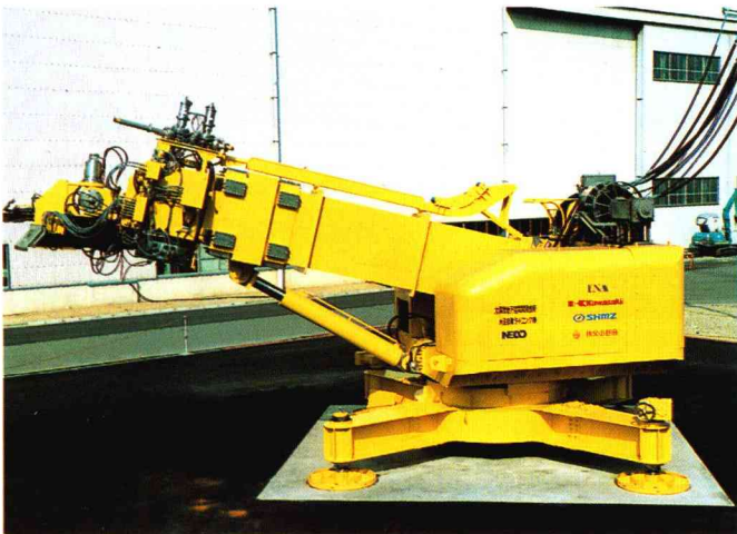
水没自動ライニング機（左）と泥水中での壁面固定試験（右）。
