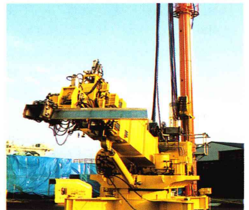
ライニング機の移動型枠部分。
