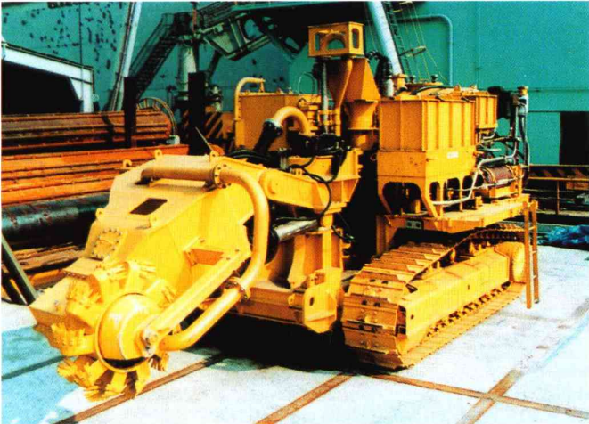
水没自動掘削機（左）と泥水中での模擬岩掘削試験（右）。
