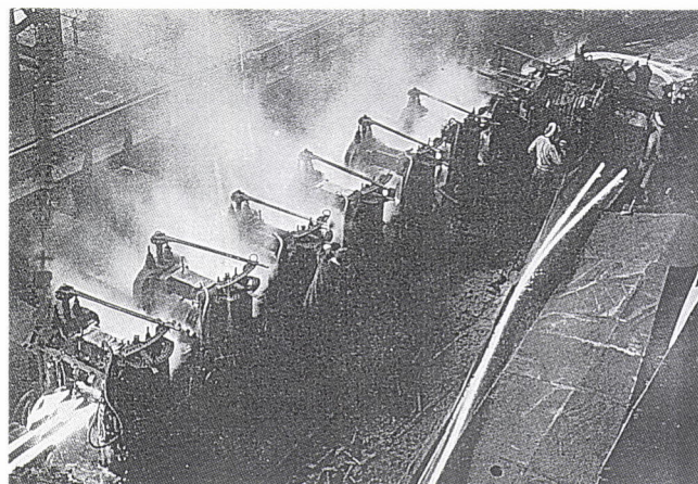
図2 半連続式線材ミル（粗列第二連続）
