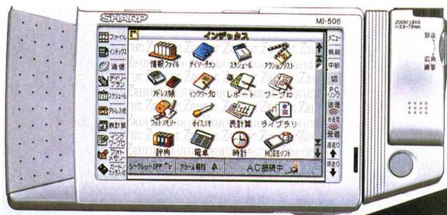
〈写真上〉パワーザウルスの主力モデル〈MI-500〉シリーズ。カラー液晶を搭載し、インターネットのホームページ閲覧も可能になっている。また購入者の約7割がデジタルカメラ付きのモデルを選択するという。内蔵リチウム電池で約8時間動く。幅161×奥行90×高さ23mm（本体のみ）、重さ315～320g（本体のみ）、価格10万円～16万8000円（デジタルカメラ付き）。〈写真右〉別売の携帯型キーボードは、パワーザウルスだけでなくザウルスポケットにも装着できる。価格9000円。
