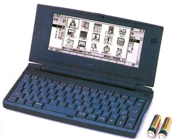
モバイルギアは内蔵メモリーを増やした新型が登場した。ラージキーボード版のモバイルギア〈MK-MC32〉(写真左上)はメモリー6MB、モノクロSTN液晶、モデムを搭載し、幅245×奥行122×高さ24.5mm、重さ550g、価格8万3000円。CE版の〈MC-CS13〉(写真右上)は、メモリー16MB、モノクロSTN液晶、モデムを搭載し、幅175×奥行97×高さ27mm、重さ400g、価格9万4000円。どちらもアルカリ単3乾電池2本で約30時間動く。東芝のPHS一体型PDA ジェニオ〈PCV100〉(写真右下)は、幅155×奥行76.5×高さ20.3mm、重さ220gのサイズに、PHS機能やインターネットのホームページ閲覧機能などを詰め込んでいる。価格オープン価格。
