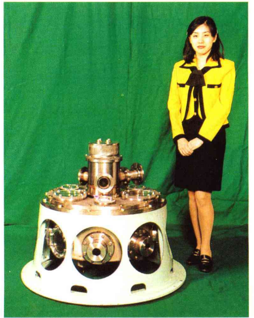
中部電力の1kWhフライホイール・ユニット実験機。
