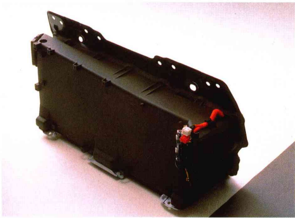
改良されたNi-MHバッテリーは、充電状態が一定に保たれるため外部からの充電は必要ない
