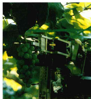
ブドウ収穫ロボット。屋外を走り回れるようクローラーを備えている。
