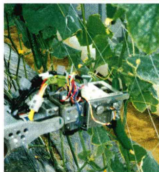
ブドウ収穫ロボット。屋外を走り回れるようクローラーを備えている。
