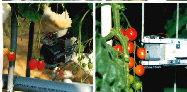
ミニトマトやイチゴの収穫ができるロボット。電気掃除機のようなパイプで吸い込んで収穫する。
