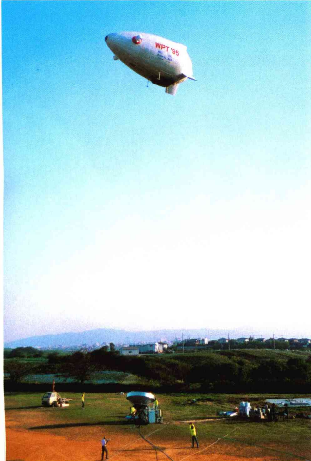
マイクロ波送電による推進実験。地上から送られたエネルギーで飛行船のモーターを回している。
