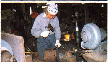
白鷹氏による釘の鍛造作業。スプリングハンマーと手鍛ちを組み合わせで鍛ち上げていく。
