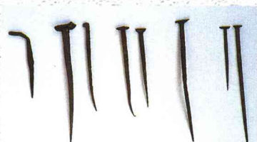
白鷹氏の古釘コレクションより（実物）。左から飛鳥時代（法隆寺）、鎌倉時代、享保年間、江戸中期（明治期に使用）、明治期のもの。すべてが釘としての形状を維持している。
