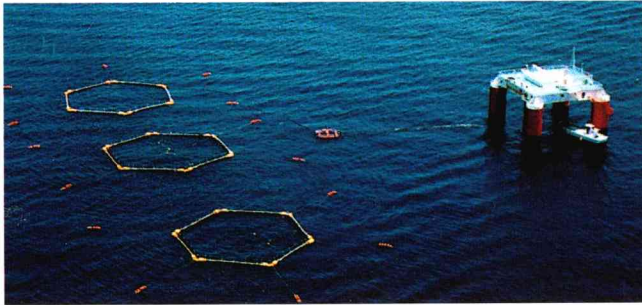
自動給餌装置や監視システムを搭載する海上ステーションと超大型生簀からなる沖合養殖システム。
