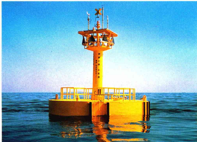
水温監視、魚群量の計測、標識機能などを備えた浮き魚礁システム。
