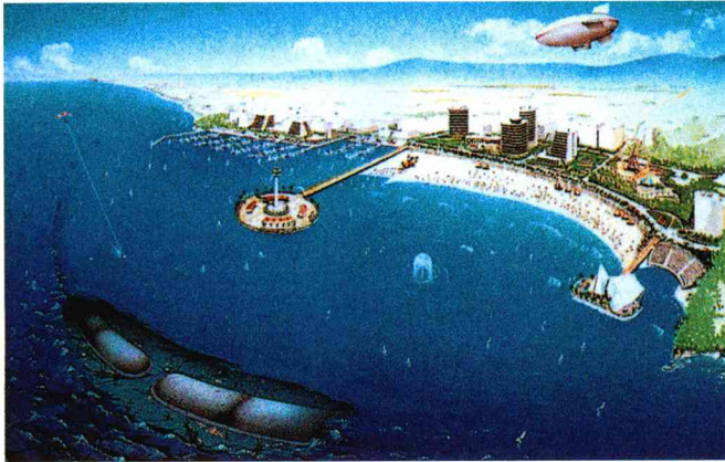
沿岸の消波機能をはたすPCハイブリッド製浮消波堤（左）とフレキシブルマウンド消波堤。
