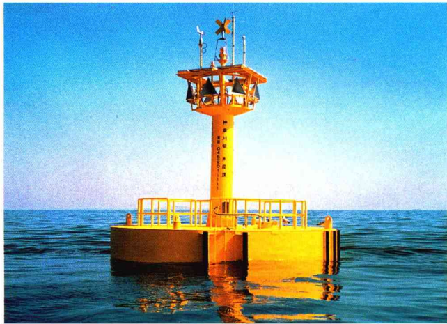
水温監視、魚群量の計測、標識機能などを備えた浮き魚礁システム。
