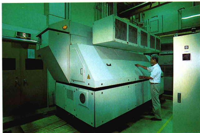
機械技術研究所の実験用CO 2 レーザー。
