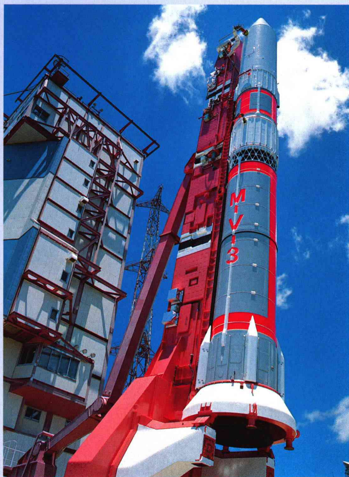
科学衛星打ち上げ用に開発された3段式固形燃料ロケットM-V-3。
