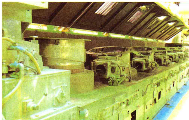
伸線機によるピアノ線の製造工程。
