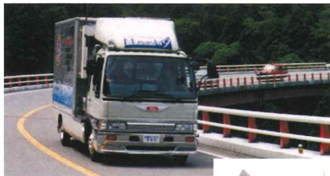
水素エンジンをトラックに搭載した9号車。箱根のような急カーブ、急勾配の道路でも実用的な性能を発揮できることが実証された。
