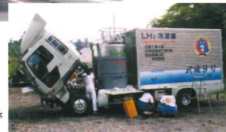
9号車の液体 水素タンク。
