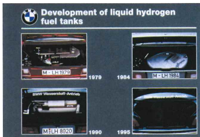
BMWの液体水素タンクの進歩。最新式ではトランクを開けてもほとんど分からない。
