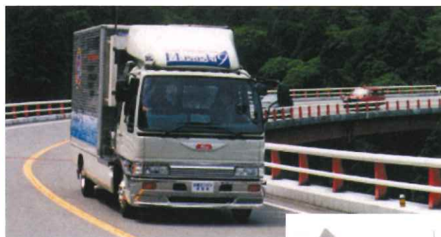
水素エンジンをトラックに搭載した9号車。箱根のような急カーブ、急勾配の道路でも実用的な性能を発揮できることが実証された。
