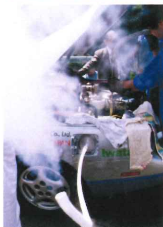
水素注入の様子。手 前はガス抜きパイプ。
