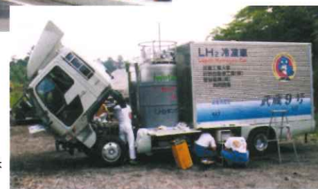
9号車の液体 水素タンク。
