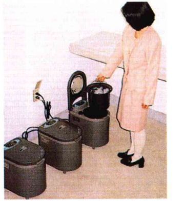
生ゴミ処理機。乾燥させ堆肥として土に混ぜる実験が行われている（エコピア蓮根）。
