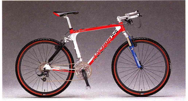
フレームに炭素繊維複合材料を使用したスポーツ用自転車（ブリヂストン）。
