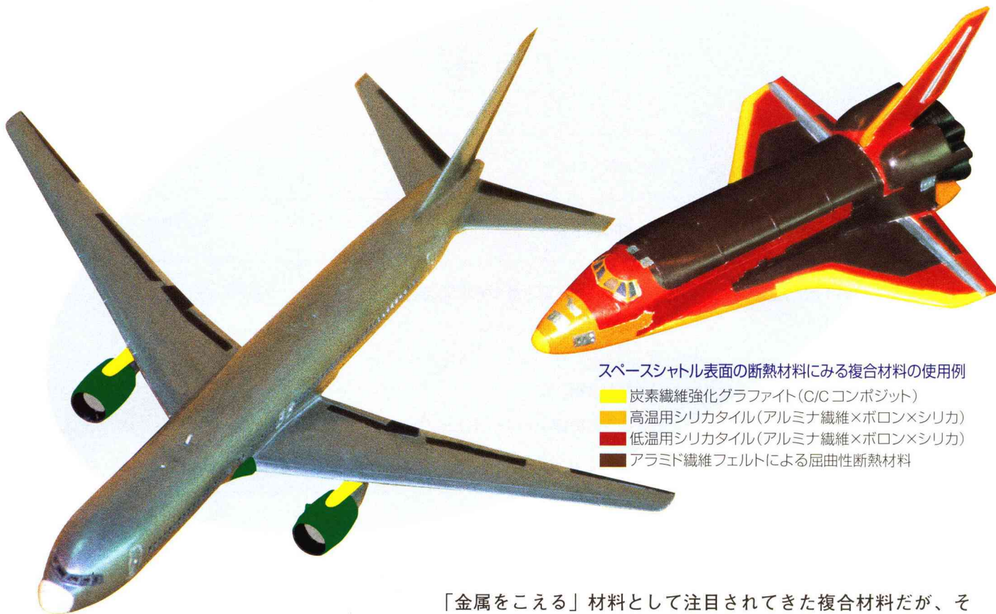
ボーイング767の外面に使われている複合材料の部位
