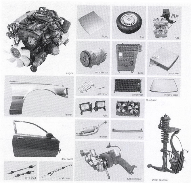
図4 中古および再生部品例(NGPグループ提供) 3)
