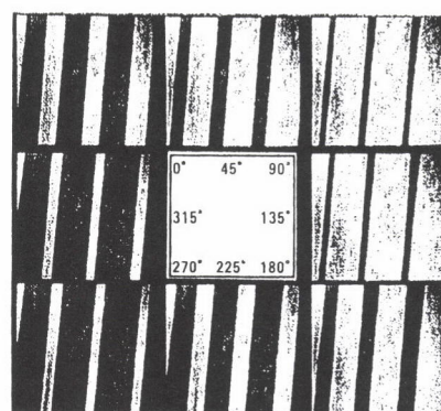
図8 方向性電磁鋼単結晶の磁壁移動の観察(表面酸化層除去後平滑化处理) 11)
