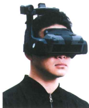
「ファイヤーブル」のHMD。CCDカメラによって搭乗者自身の姿を仮想画面中に合成することが可能に。超音波・ジャイロ併用方式による高速3次元センサー・システムを採用することで、頭の動きと画面の動きの時間差を解消することに成功している。 ©(株)ナムコ
