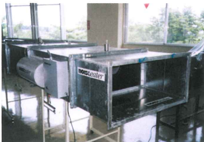
ダクトに取り付けられたANCの例（ミツヤ送風機製作所）。
